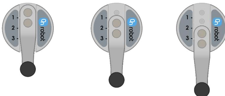
В комплект поставки входят пальцы длиной 49 мм («L» на рисунке ниже). Если требуются специальные пальцы, их можно изготовить в соответствии со следующими размерами (мм) пальцев захватного устройства. Для крепления используются винты M4x8 мм (момент затяжки: 3 Н·м):
