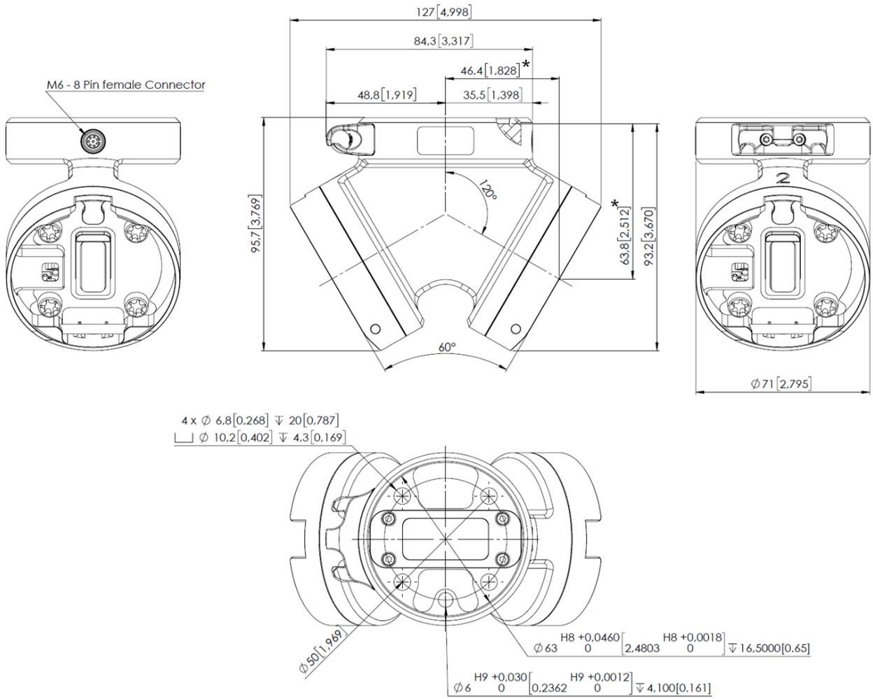
\* 机器人凸缘接口到 OnRobot 工具的距离
