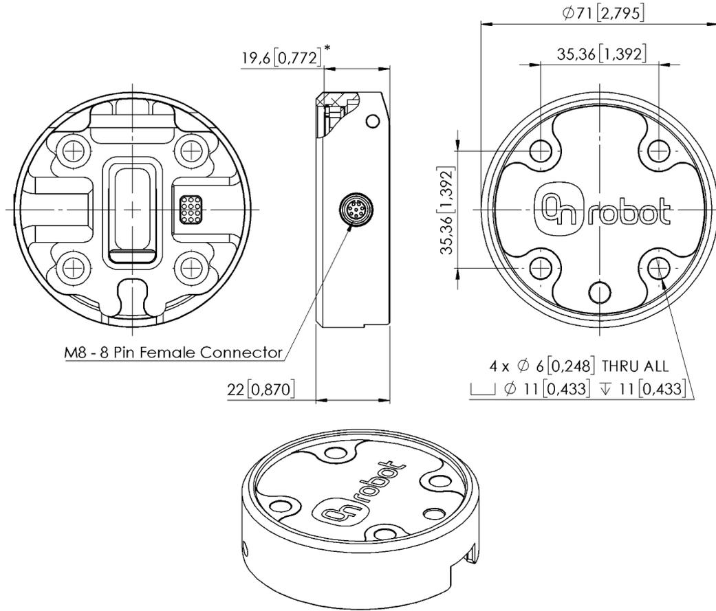
\* 机器人凸缘接口到 OnRobot 工具的距离
