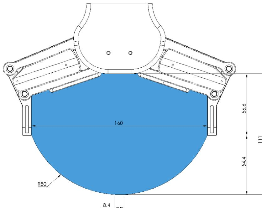
長い物体を把持すると、意図せず安全スイッチが作動する可能性があります。ワークピースの高さの上限（フィンガーチップの端から計算される）は、把持の幅（ $w$ ）によって異なります。さまざまな幅の値に対する高さ（ $h$ ）の上限を以下に示します。
